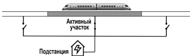
Рисунок 5 – Посекционная работа системы асинхронного двигателя в EMS-системе
