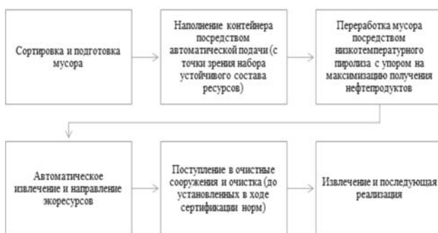
Рис. 2. Бесконтактная переработка мусора посредством пиролизного метода.
